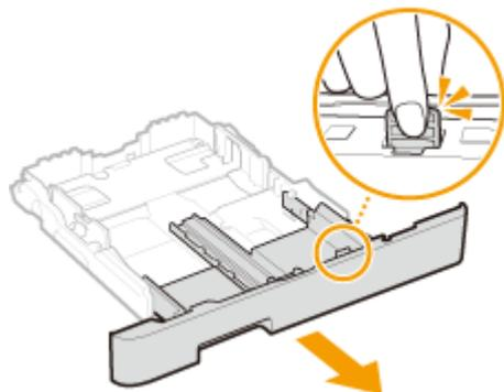
**3 装入纸张，使纸叠的边缘靠紧纸盒前侧的纸张导板。**
